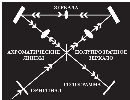
Рисунок 5 — Схема построения ахогерентной голограммы
